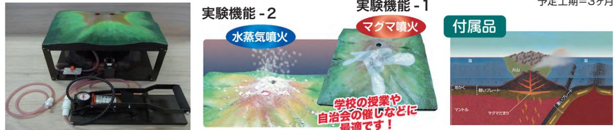
ポンプで模型の地下部分の圧力を上げ、スイッチを押すと噴出が始まります
