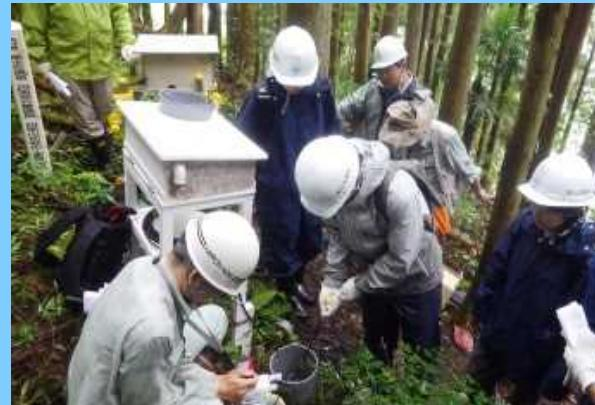
孔内傾斜計観測及び地下水調査
