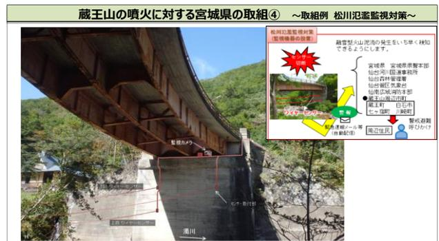
を設置しております。火山泥流の通過時にワイヤーセンサーの切断を感知し、関係機関に情報が自動配信され、周辺住民の迅速な避難に繋げるものです。下流側流路工が整備中であることなどを踏まえ、噴火時の人的被害の防止のため先行して整備したものです。以上です。
