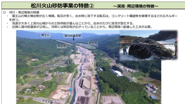
河川としての松川の特徴としては、広い区間に渡って火山堆積物、転石などが堆積しております。中には、直径2メートルを超える岩があり、出水時にはこれらの転石がぶつかりながら流下し、コンクリート構造物でも破壊されてしまいます。
