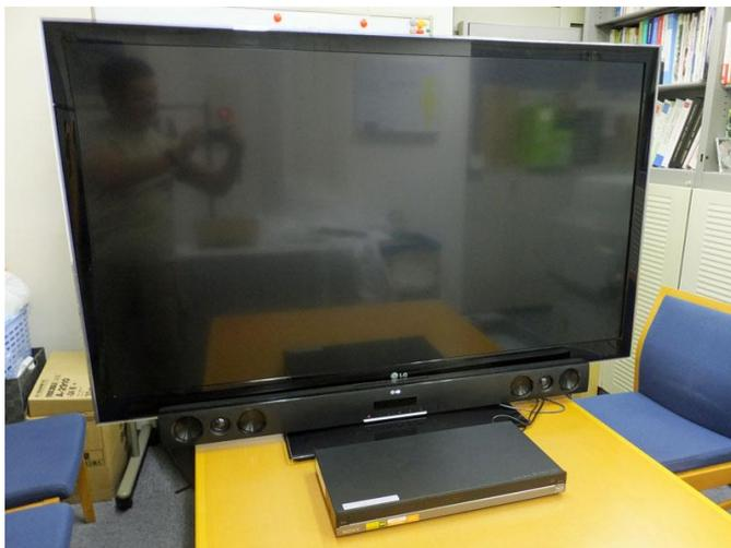
配置が完了したら3Dモニター背面にテーブルタップを配置して各機器の電源コードをセットしてください。
