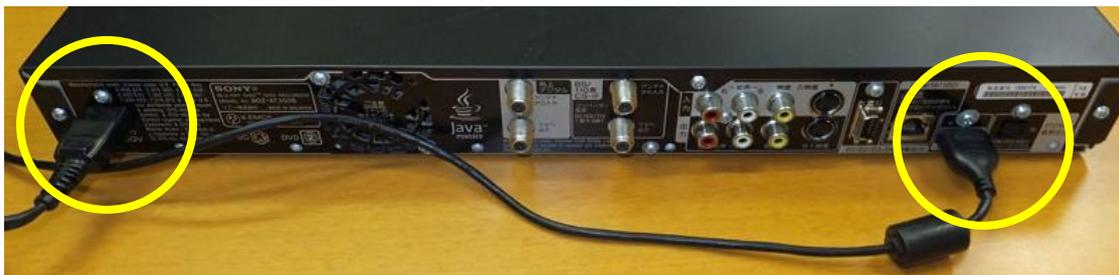
背面の上写真の左端にある『電源入力』に電源コードを差し込みます。
