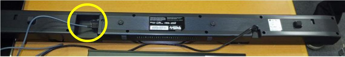
初めにサラウンドスピーカー背面の右写真の位置にある音声入力端子『OPTICAL IN 1』に、保護キャップを外した光デジタルケーブルの一方を差し込んでください。
