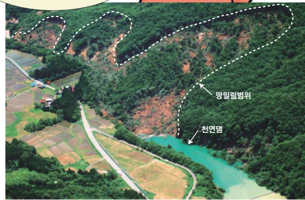
이와테(岩手) 미야기(宮城) 내륙지진으로 발생한 하도폐색 (2008년 이와테현 이치노세키시(一関市)) 토사로 하천이 막혀 천연댐이 되어있습니다.
