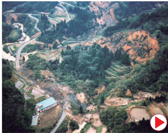
니가타현(新潟県) 류에츠(中越)지진으로 발생한 땅밀림 (2004년 니가타현 나가오카시(長岡市) <구·야마코시마(山古志村) 히가시타케계곡(東竹沢)>) 지진도 땅밀림을 일으키는 원인이 됩니다.
