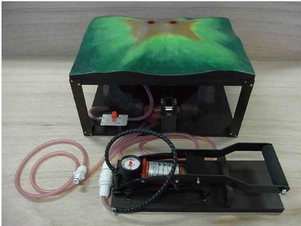
ポンプで模型の地下部分の圧力を上げ、スイッチを押すと噴出が始まります
