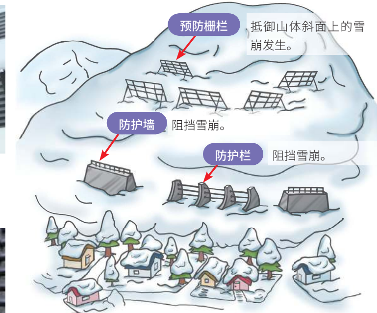
防护栏 在山脚下修建防护栏，和防护墙。即便发生雪崩，也能防止直接冲击民房。
