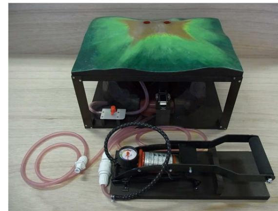
ポンプで模型の地下部分の圧力を上げ、スイッチを押すと噴出が始まります
