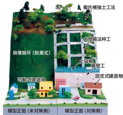
・レバーを引くと斜面が崩壊。崩壊の様子と対策が学べます。
