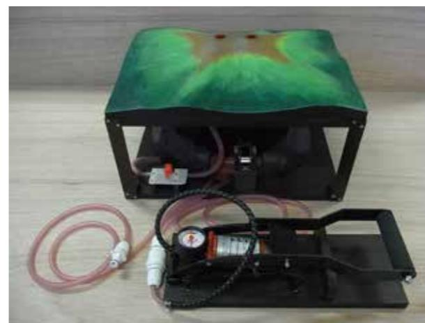
ポンプで模型の地下部分の圧力を上げ、
