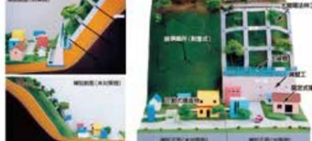
**実験 対策前の模型で急傾斜地崩壊が発生**
