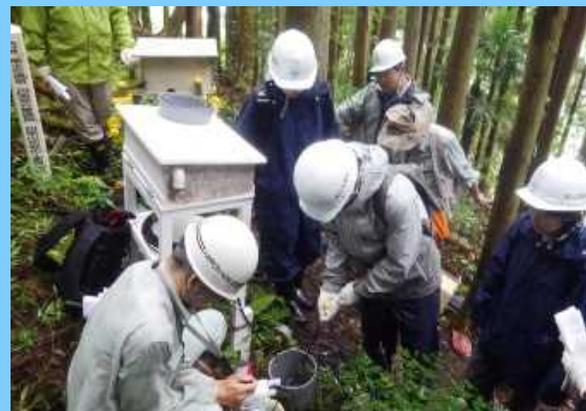
孔内傾斜計観測及び地下水調査
