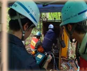
現場体験:孔内傾斜計による観測体験(地すべり挙動の把握)
