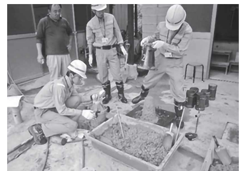
写真-3 スランプ試験の体験 (渡良瀬川河川事務所)
