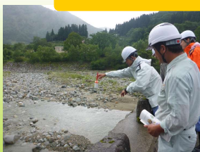
流速を測るための浮子 投下を体験
