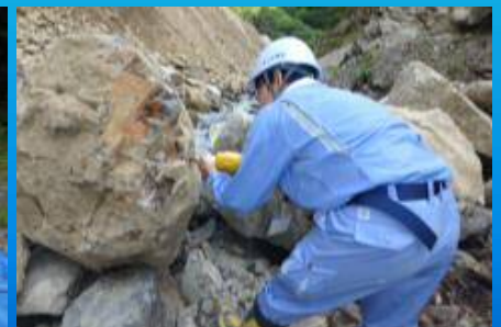
工事現場体験（シュミットハンマー体験）
